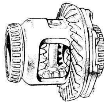
Рис. 128. Дифференциал переднего моста в сборе
